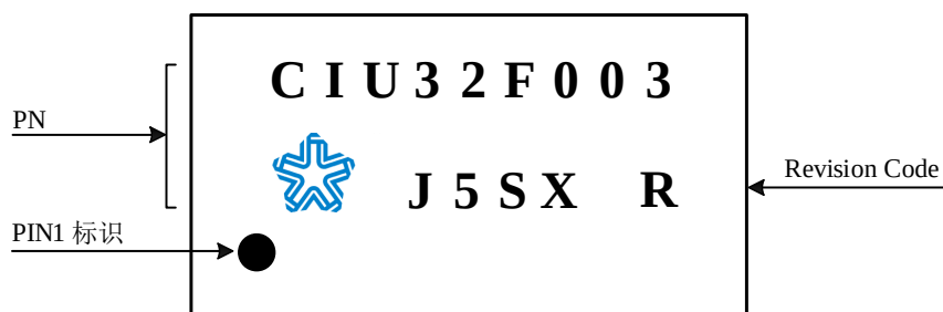
图 5-8 SOP8 封装丝印信息说明
