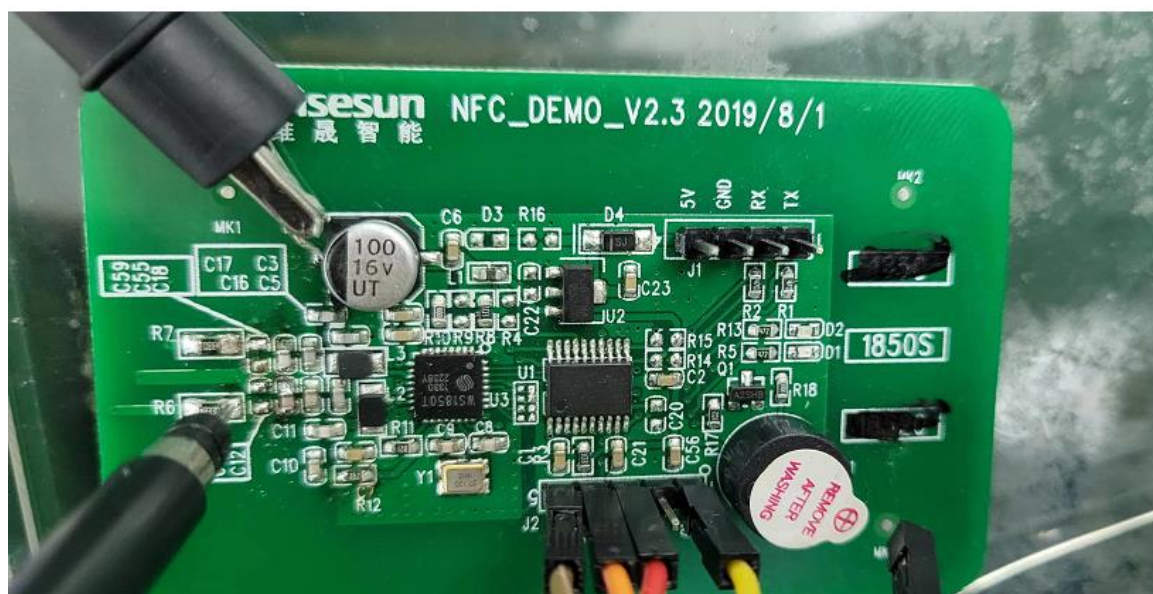
图 11：观测 TX 峰峰值的测试点
