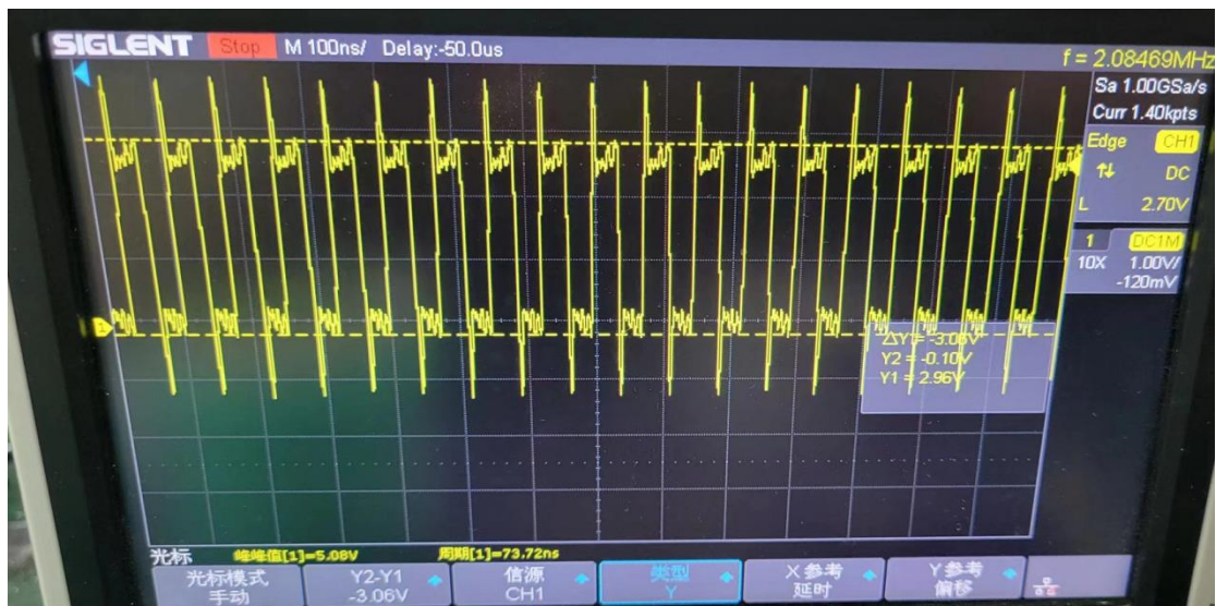
图 10: 芯片 TX 引脚 13.56MHz 方波
