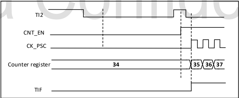
图 18-36 触发器模式下的控制电路
