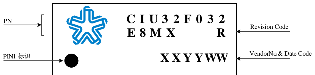
图 5-8 SSOP24 丝印信息说明
